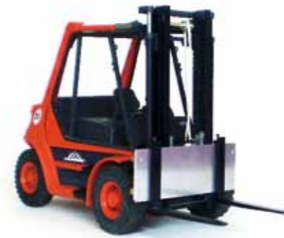
Elektrischer Seitenschieber: die Idee hierzu wurde durch die Anfrage eines Modellbauers geboren
