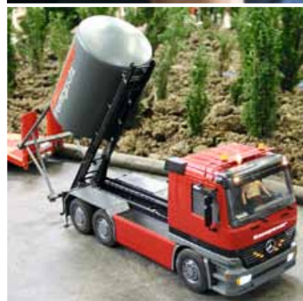
Trotz Platzproblemen konnten bei diesem Silosteller mit Hydraulik alle Funktionen realisiert werden
