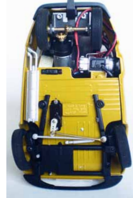
Neben dem schräg eingebauten Antriebsmotor befindet sich die Motorattrappe
