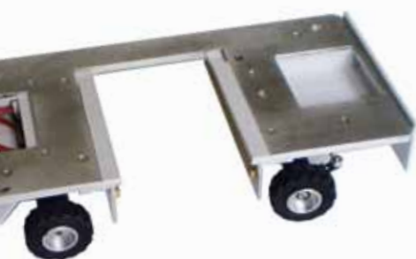
Die Grundplatte für das Fahrgestell besteht aus CNC-gefrästem Aluminium
