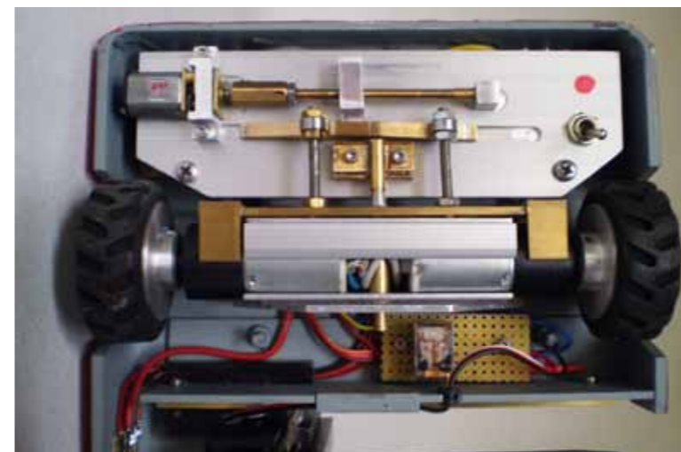
Gut zu erkennen sind die Mechanik für die Kippfunktion und das Relais für das Umschalten zwischen Hub- und Ausschub
